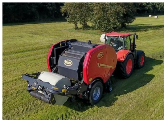
Déchargement au plus près du sol
