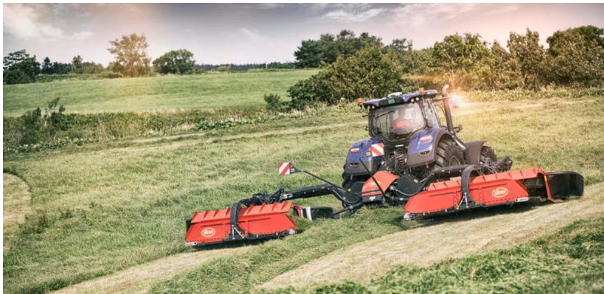
La nouvelle combinaison de faucheuses Vicon EXTRA 7100 BX avec une largeur de travail de 10 m et tapis groupeurs.
