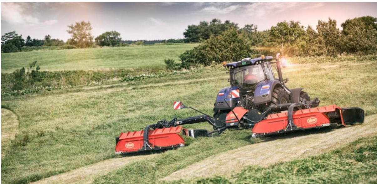
La nouvelle faucheuse triple Vicon EXTRA 7100 BX avec une largeur de travail de 10 m et des tapis groupeur.
