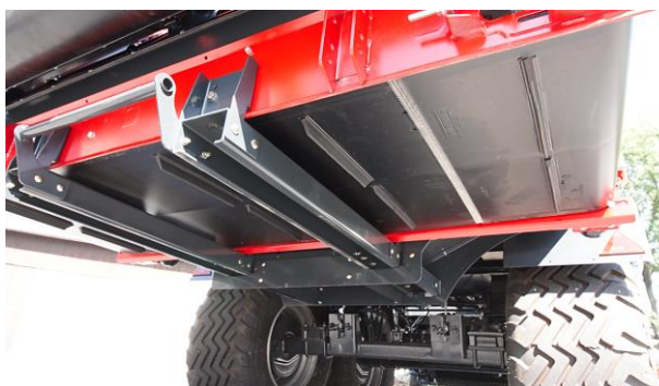
Une conception de châssis robuste adapté pour recevoir un tapis convoyeur
